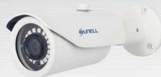
Telecamera bullet 4 in 1, AHD / CVI / TVI / CVBS risoluzione massima 1080p FULL-HD, sensore 1/2,9" SONY CMOS da 2 Mpixel, ottica fissa 3,6 mm, OSD controllabile via Joystick, uscita video di default AHD 1080p, 18 led SMD di nuova generazione per una illuminazione notturna ottimale fino a 15 m, 2D/3D-DNR, dWDR, BLC, menù OSD in lingua Italiana, alimentazione 12 Vcc.
