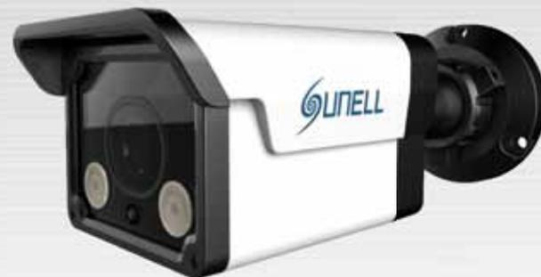
Telecamera bullet IP H.265, risoluzione 4 Mpixel, ottica fissa 3,6 mm (84°), sensore 1/3" Progressive Scan CMOS, risoluzione 2592x1520 20 fps / 2304x1296 30 fps / 1920x1080 30 fps, 2 led IR Array proporzionali per una illuminazione fino a 30 m, 2D/3D-DNR, WDR > 120 dB, ICR, menù OSD in lingua italiana, compressione H.265/H.264/MJPEG, compatibile ONVIF Profilo G e S, CGI, Main stream 500÷12000 kbps, Sub Stream 100÷6000 kbps, IP66, alimentazione 12 Vcc / POE.
