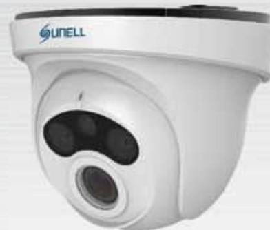
Telecamera eyeball antivandalo IP risoluzione 4 Mpixel, ottica fissa da 2,8 mm (89°), risoluzione 2688x1520 15 fps / 2560x1440 15 fps / 2304x1296 20 fps / 1920x1080 30 fps, sensore da 1/3" Progressive Scan CMOS, 2 led IR Array per una illuminazione fino a 15 m, 2D/3D-DNR, dWDR, ICR, menù OSD in lingua Italiana, compressione H.264 High/Main/Baseline e MJPEG, compatibile ONVIF Profilo G e S, CGI, Main stream 500÷12000 kbps, Sub stream 100=6000 kbps, IP66, alimentazione 12 Vcc / POE.
