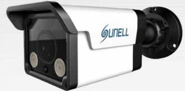
Telecamera bullet IP risoluzione 2 Mpixel, ottica fissa da 2,8 mm (75°), risoluzione 1920x1080 30 fps / 1280x720 30 fps, sensore da 1/3" Progressive Scan CMOS, Smart IR, 2 led IR Array per una illuminazione fino a 30 m, 2D/3D-DNR, dWDR, ICR, menù OSD in lingua Italiana, compressione H.264 High/Main/Baseline e MJPEG, compatibile ONVIF, CGI, Main stream 500÷12000 kbps, Sub stream 100÷6000 kbps, IP66, alimentazione 12 Vcc / POE.
