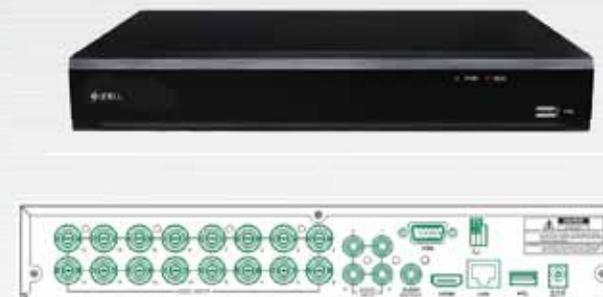
Videoregistratore digitale 4 Mpixel 5 in 1, 16 ingressi BNC (AHD fino a 4 Mpixel/TVI/CVI fino a 4 Mpixel, CVBS 960H) + 8 fusti video IP. 16 ingressi audio / 1 uscita, 16 ingressi allarme / 1 uscita, funzione P2P e DDNS proprietario Eurogroup, uscite video HDMI 4K e VGA, gestione di 2 HDD da massimo 6 TB cad per un totale massimo di 12 TB, controllo Coaxitron via cavo coassiale del menù / zoom / PTZ delle telecamere abilitate, porta RS485, 2 porte USB, alimentazione 12 Vcc, alimentatore incluso.
