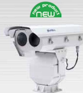
Telecamera bullet termica IP, risoluzione 396x264, sensore Uncooled IRFPA, sensibilità termica 50 mK, lunghezza d'onda rilevata 8÷14 µm, ottica da 100 mm, possibili visualizzazioni: bianco/nero, effetto incandescente, effetto arcobaleno ed effetto ruggine. IP66, alimentazione 24 Vca.
