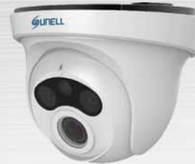
Telecamera eyeball IP risoluzione 2 Mpixel, ottica fissa da 2,8 mm (89°), risoluzione 1920x1080 30 fps / 1280x720 30 fps, sensore da 1/2,9" Progressive Scan CMOS, 2 led IR Array per una illuminazione fino a 15 m, 2D/3D-DNR, dWDR, ICR, menù OSD in lingua Italiana, compressione H.264 High/Main/Baseline e MJPEG, compatibile ONVIF, CGI, Main stream 500÷12000 kbps, Sub stream 100÷6000 kbps, IP66, alimentazione 12 Vcc / POE.
