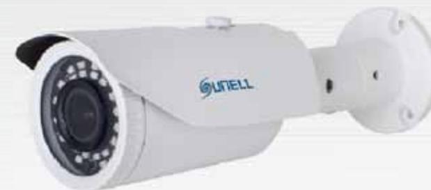
Telecamera bullet 4 Mpixel AHD, risoluzione massima 1440p (2560x1440), sensore 1/3" CMOS da 4 Mpixel, ottica varifocale 2,8÷12 mm, OSD controllabile via Joystick, uscita video fissa AHD 4 Mpixel, 30 led IR SMD di nuova generazione per una illuminazione notturna ottimale fino a 40 m, 2D-DNR, dWDR, BLC, HLC, 4 zone privacy, menù OSD in lingua Italiana, alimentazione 12 Vcc.
