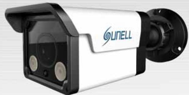
Telecamera bullet IP risoluzione 4 Mpixel, ottica fissa da 3,6 mm (75°), risoluzione 2688x1520 15 fps / 2560x1440 15 fps / 2304x1296 20 fps / 1920x1080 30 fps, sensore da 1/3" Progressive Scan CMOS, Smart IR, 2 led IR Array per una illuminazione fino a 30 m, 2D/3D-DNR, dWDR, ICR, menù OSD in lingua Italiana, compressione H.264 High/Main/Baseline e MJPEG, compatibile ONVIF Profilo G e S, CGI, Main stream 500÷12000 kbps, Sub stream 100÷6000 kbps, IP66, alimentazione 12 Vcc / POE.
