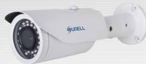
Telecamera bullet 4 in 1, AHD / CVI / TVI / CVBS risoluzione massima 1080p FULL-HD, sensore 1/2,9" SONY CMOS da 2 Mpixel, ottica varifocale 2,8÷12 mm, OSD controllabile via Joystick, uscita video di default AHD 1080p, 30 led SMD di nuova generazione per una illuminazione notturna ottimale fino 40 m, 2D/3D-DNR, dWDR, BLC, menù OSD in lingua Italiana, alimentazione 12 Vcc.
