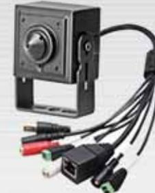
Telecamera Pin-hole IP risoluzione 1,3 Mpixel, ottica fissa pin-hole da 3,7 mm (57°), risoluzione 1280x720 30 fps, sensore da 1/3" Progressive Scan CMOS, 2D/3D-DNR, dWDR, menù OSD in lingua Italiana, slot per memorie SD, 1 ingresso allarme / 1 uscita, 1 ingresso audio/ 1 uscita, compressione H.264 High/Main/Baseline e MJPEG, compatibile ONVIF, Main stream 1000÷8000 kbps, alimentazione 12 Vcc.
