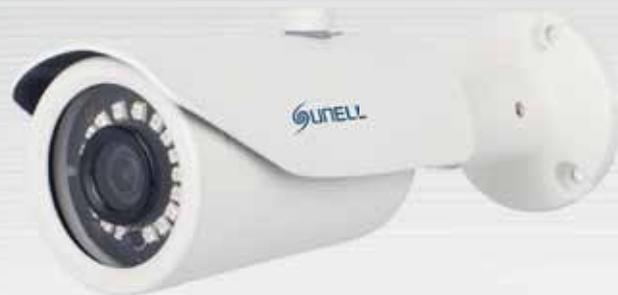
Telecamera bullet 4 Mpixel AHD, risoluzione massima 1440p (2560x1440), sensore 1/3" CMOS da 4 Mpixel, ottica fissa 3,6 mm, OSD controllabile via Joystick, uscita video fissa AHD 4 Mpixel, 18 led IR SMD di nuova generazione per una illuminazione notturna ottimale fino a 15 m, 2D-DNR, dWDR, BLC, HLC, 4 zone privacy, menù OSD in lingua Italiana, alimentazione 12 Vcc.
