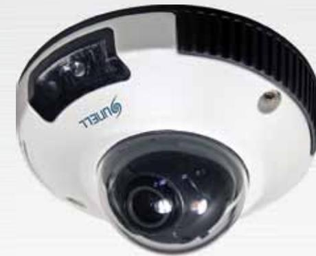
Telecamera dome antivandalo IP H.265, risoluzione 4 Mpixel, ottica fissa 2,8 mm (89°), sensore 1/3" Progressive Scan CMOS, risoluzione 2592x1520 20 fps / 2304x1296 30 fps / 1920x1080 30 fps, 1 led IR per una illuminazione fino a 10 m, 2D/3D-DNR, WDR> 100 dB, ICR, menù OSD in lingua italiana, compressione H.265/H.264/MJPEG, compatibile ONVIF, CGI, Main stream 500÷12000 kbps, Sub Stream 100÷6000 kbps, IP65 / IK8, alimentazione 12 Vcc / POE.
