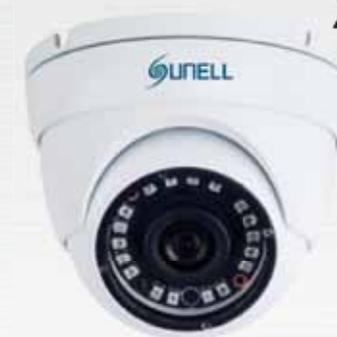
Telecamera eyeball 4 in 1, AHD / CVI / TVI / CVBS risoluzione massima 1080p FULL-HD, sensore 1/2,9" SONY CMOS da 2 Mpixel, ottica fissa 3,6 mm, OSD controllabile via Joystick, uscita video di default AHD 1080p, 18 led SMD di nuova generazione per una illuminazione notturna ottimale fino a 15 m, 2D/3D-DNR, dWDR, BLC, menù OSD in lingua Italiana, alimentazione 12 Vcc.
